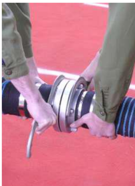
Rys. 8b: Nakładanie kluczy i łączenie węży ssawnych.
