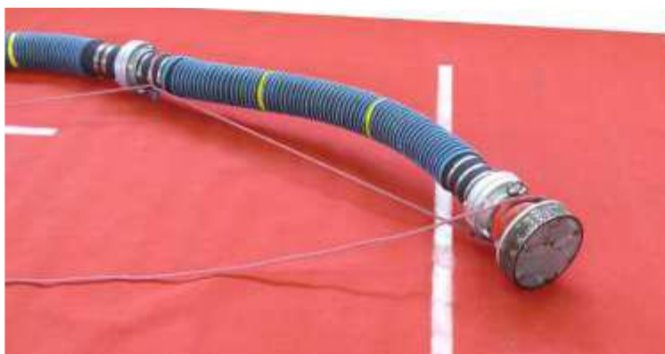
Rys.13: Odłożenie smoka ssawnego za czerwoną listwę.
